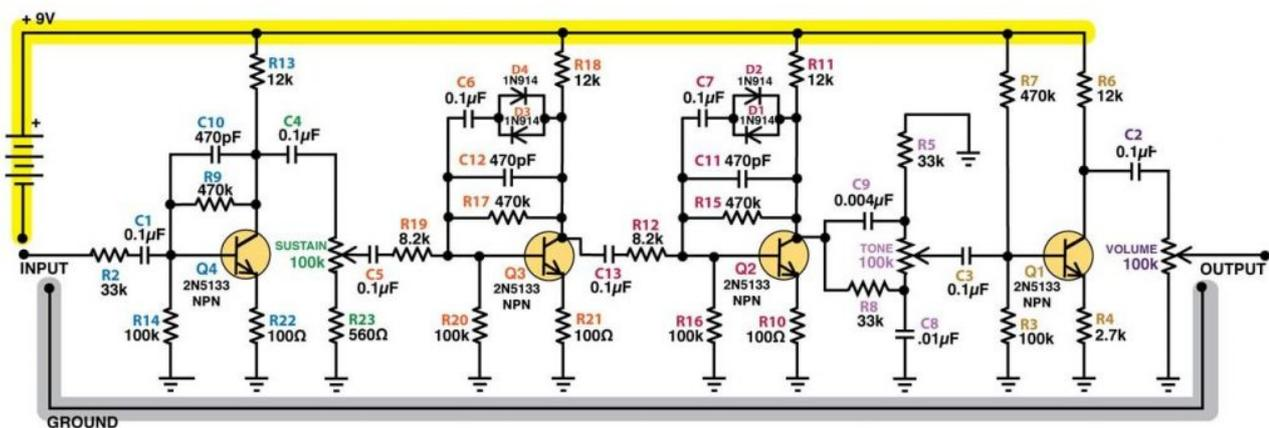
Anstelle der Transistoren 2N5133 wurden BCY58-10 und als Dioden BAT43 verbaut. Für C9 wurde ein 3.9nF Keramikkondensator eingesetzt.
